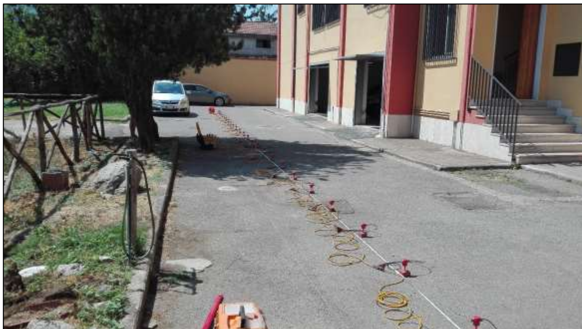
Foto generale che illustra lo stendimento geofonico eseguito presso la stazione di comando dei Carabinieri del Comune di Castel San Giorgio (SA)
